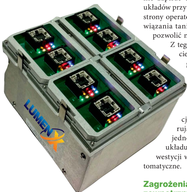
Fot. 1. Programator LumenX o szybkości zapisu ponad 80 MB/s
