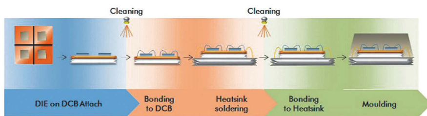
Rys. 1. Mycie w produkcji modułów mocy może być wymagane na dwóch etapach procesu produkcji
