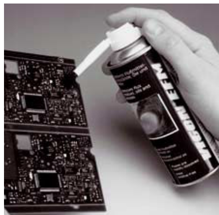
Rys. 1. Najłatwiejszym sposobem mycia w procesie elektronicznym jest mycie ręczne na przykład za pomocą specjalnych szczoteczek ESD oraz przygotowania stanowiska z wyciągiem
