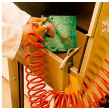
Rys. 1. Najłatwiejszym sposobem mycia w procesie elektronicznym jest mycie ręczne na przykład za pomocą specjalnych szczoteczek ESD oraz przygotowania stanowiska z wyciągiem
