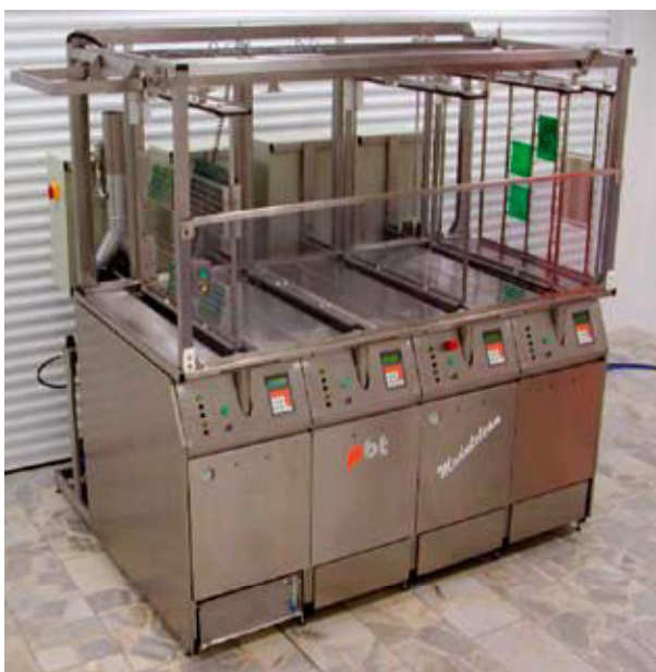
Rys. 7. W takiej konfiguracji można umyć ok. 8–12 szablonów na godzinę lub ok. 2–3m 2 płytek PCB
