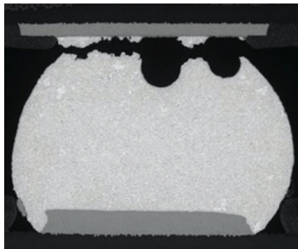
Fot. 2. Pęknięta kulka BGA
