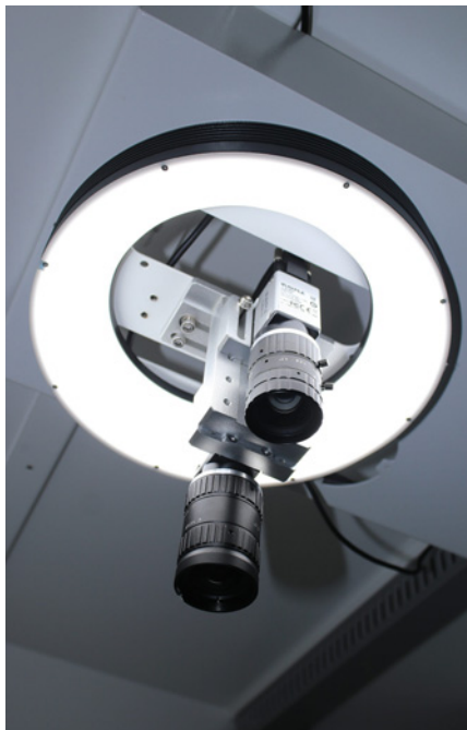
Fot. 1. Nowy system kamer w X-Scope 3000
