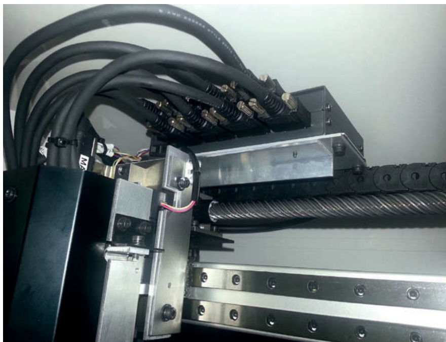
Rys. 4. Połączenie transmisyjne w AOI Maranza typu CameraLink przez podwójny multiplexer
