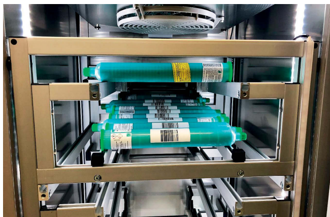
Rys. 1. Podświetlenie i wysuwana półka ze stojakiem na rolki z komponentami SMD w szafie XSD
