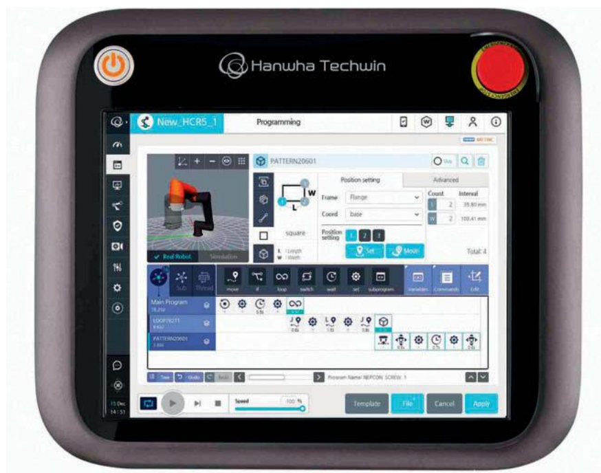
Rys. 1. Panel programowania cobota
